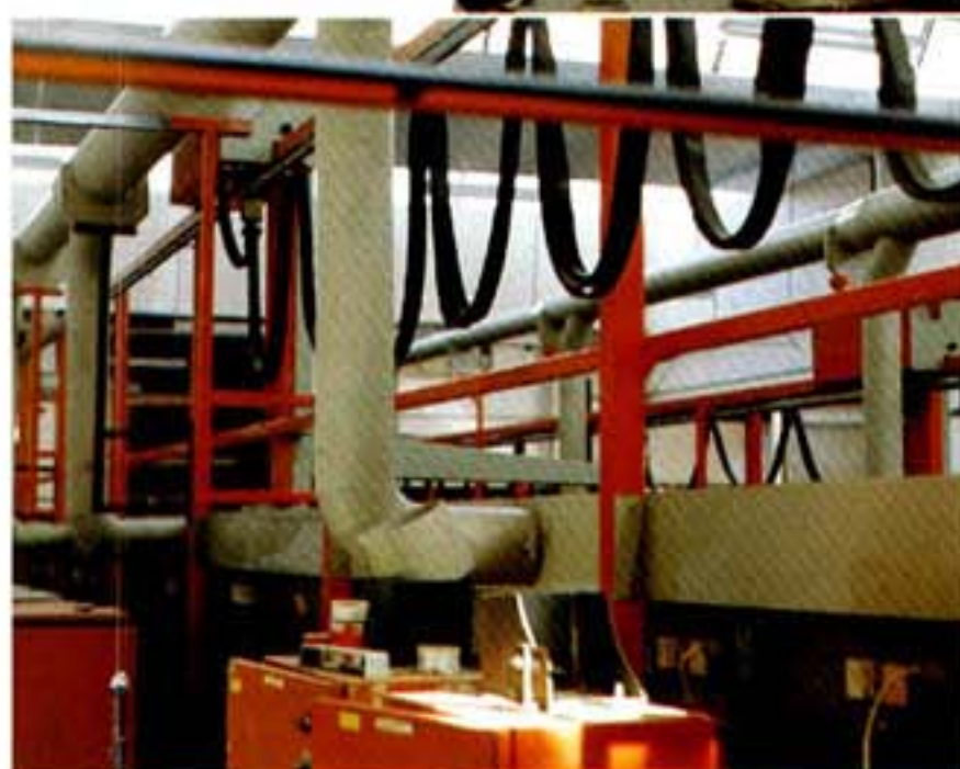
Detalles de diferentes partes de una instalación de tratamiento galvanizado, en la que se aprecian cubas, colectores de aspiración, desagües y red de suministro de productos.
