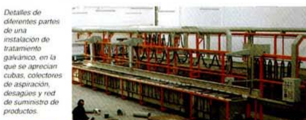
Detalles de diferentes partes de una instalación de tratamiento galvanizado, en la que se aprecian cubas, colectores de aspiración, desagües y red de suministro de productos.
